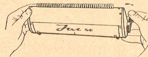
Der Griff wird gefühlig nach hinten gedrückt bis er dort einrastet. Alle 40 Wählerstifte gleiten nach oben.
