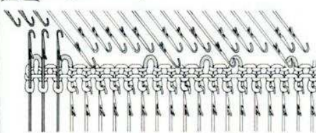
Aiguilles en position d'attente (position E)
