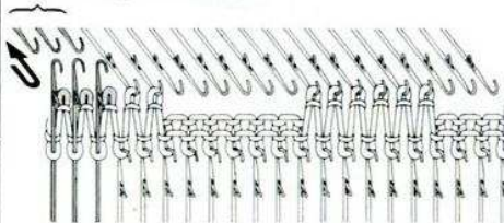
Aiguilles en position d'attente (position E)
