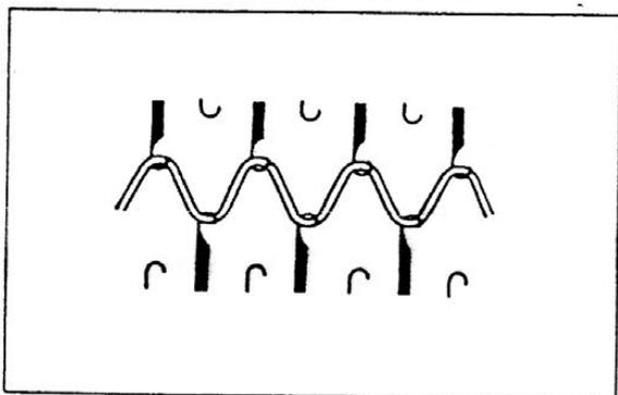
4. Legen Sie den Faden mit der Hand von links nach rechts in 1 / 1 Technik ein .
