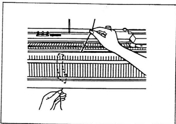
3. Nehmen Sie den Faden für das Deckgestrick und ziehen Sie den Faden zwischen den beiden Nadelbetten nach unten . Befestigen Sie das Fadenende an der Halteklammer .
