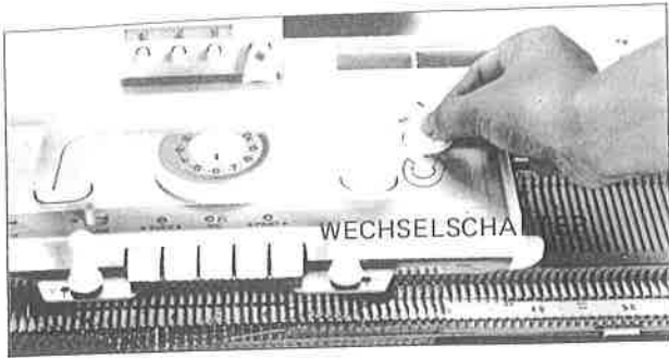
3. Drehen Sie den Wechselschalter auf CR.
