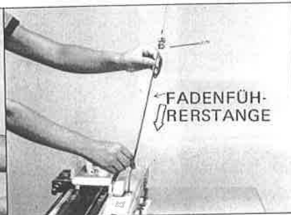
4). Stecken Sie den Fadenführer in die Halterung am hinteren Rand der Maschine.
