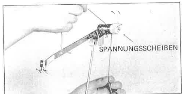
2. Führen Sie die Wolle zwischen die beiden gefederten Scheiben. Schieben Sie mit gespanntem Faden die äußere Scheibe zur Seite und lassen Sie die Wolle unter den Sicherungsstift gleiten.
