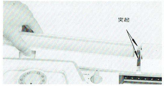
(14) フタの2個の突起を部品箱の右側の穴に差し込み、フタを閉じます。
