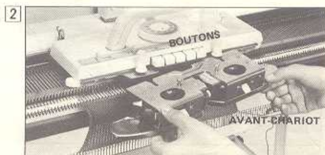
2) Desserrez les boutons et enlevez l'avant-chariot du chariot K.
