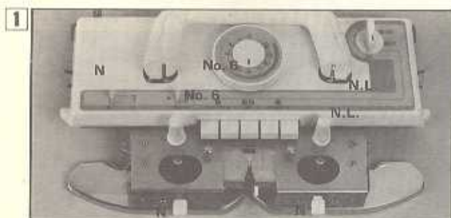
1 Posez le chariot K. (Les instructions suivantes sont basées sur une tension 6)
