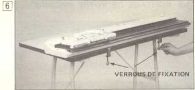
Fixez la machine sur la table au moyen des verrous de fixation.
