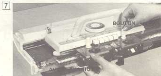
7) Desserrez les boutons et enlevez l'avant-chariot du chariot K.
