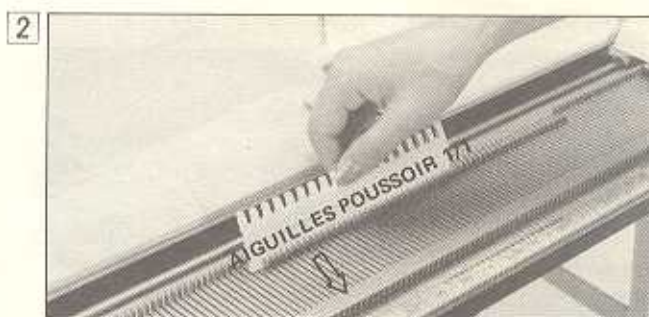
2 A l'aide du poussoir 1/1 avancez 60 aiguilles de la fonture avant en position B (30 aiguilles de chaque côté de la marque "0").
