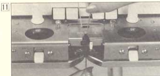
11 Enfilez le fil de seconde couleur, qui était maintenu sous le clip, dans le guide-fil B sans ouvrir le levier du guide-fil. Maintenez le fil sous le guide-fil avec la main gauche.
