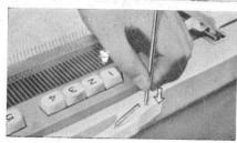
10. Den Stab für die Fadenführung welcher unter dem Zubehörkasten befestigt ist, am Griff bzw. an der vorgesehenen Haltarung einsetzen.
