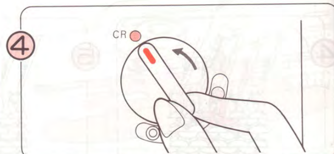
Placez le sélecteur du CR pour dégager le chariot K de la machine.
