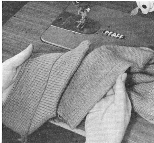
Abb. 2 (links): Exakte Naht und sauberes Säumen (auf der rechten Seite ist kein Stich zu sehen) mit der Nähmaschine.
