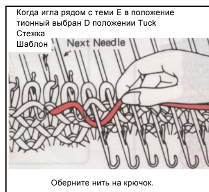
Оберните нить, пропуская ее под ствол первой иглы в E положении, как показано.
