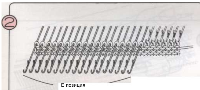
На противоположной стороне в К-каретки, внести в положение E (НР) те иглы, которые вы не хотите вязать.
