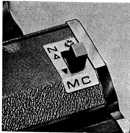
(7) Cuando la palanca MC se coloca en la posición MC las agujas correspondientes se levantarán a la posición D al accionar la palanca selectora de agujas.
