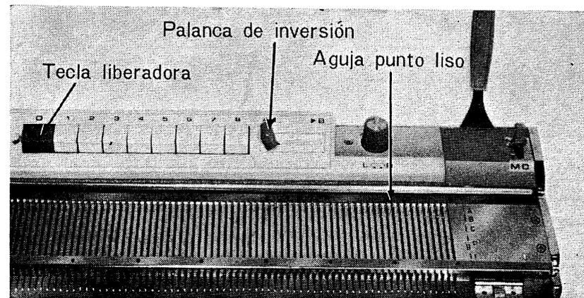
(2) Presione la tecla liberadora y coloque la palanca de inversión en posición "A" y empuje hacia atrás todas las agujas de forma que queden en posición "A".
