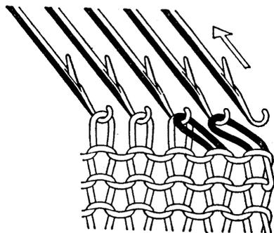
\*Utilizar el transferidor 2x2 para transferir dos puntadas al extremo de las agujas interiores, y situar la aguja vacía en posición "A".
