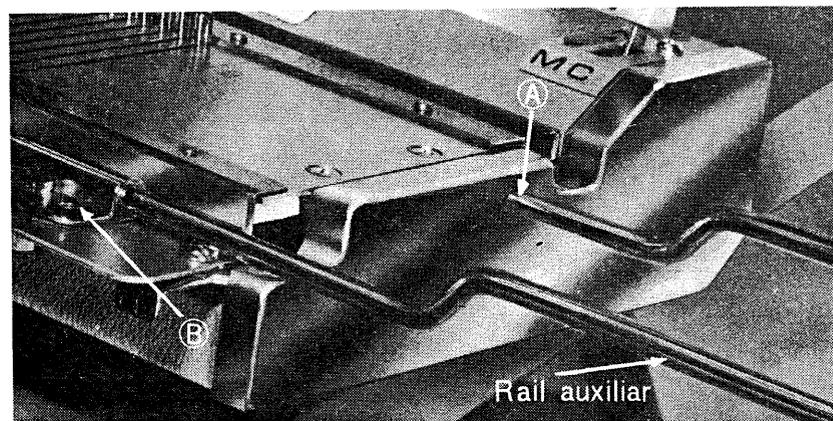
(2) Introducir el rail auxiliar en el orificio A por debajo del seguro de rail auxiliar B, en el extremo de la máquina de tejer.
