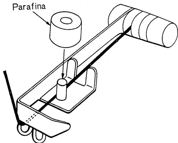
Al utilizar hebra de dos cabos o hilo de encaje situar la parafina en el perno sobre la guía frontal de hebra.
