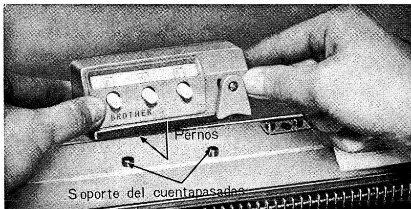
(12) Colocar el contador de pasadas sobre los pernos (colocar los pernos en las aperturas del plato inferior)
