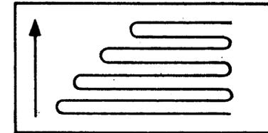
Tomamos como ejemplo un tejido del tipo de retención con el propósito de explicar el procedimiento. Una aguja de cada cuatro tiene 2 puntadas de retención y dos puntadas sencillas alternativamente. Colocar las palancas de las levas en posición "III".
