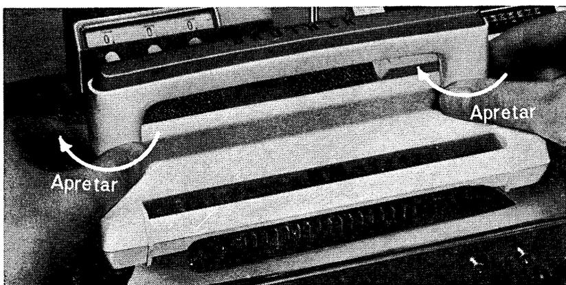
(3) Sujetar la empuñadura sobre el carro L.
