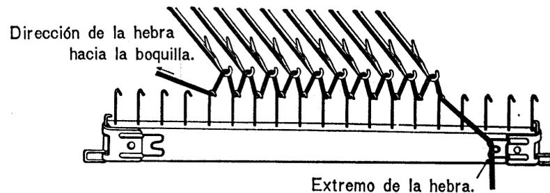
(15) Para que no se deshagan las puntadas y que el extremo de la hebra no estorbe al tejer, se sujeta ésta en el gancho del peine según se indica en la figura.
