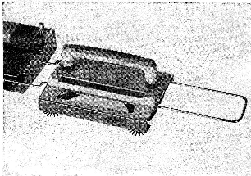
«Para volver a poner el carro "L" sobre el rail auxiliar»
