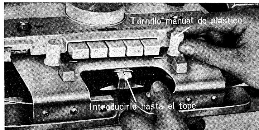
(10) Aflojar los tornillos de plástico del carro, introduciendo la boquilla todo lo que dé de sí y apretad los tornillos.
