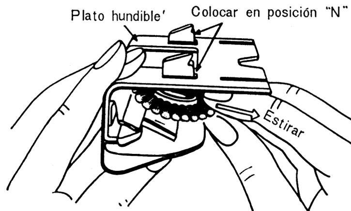
Insertar la abrazadera entre el eje del cepillo de hebra intercalada y el muelle, hasta el tope.
