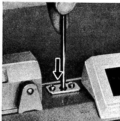
(17) Colocar en el orificio que existe en el centro de la máquina la varilla de forma que la guía de hebra quede opuesta a
