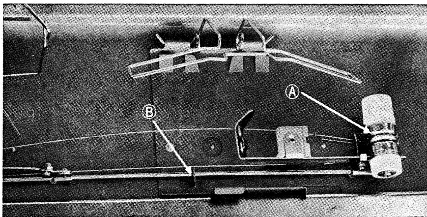
(6) Colocar el dispositivo automático de tensión de hebra como se indica en la figura. (Colocar la cabeza ① del dispositivo bajo de la abrazadera ② de la funda).
