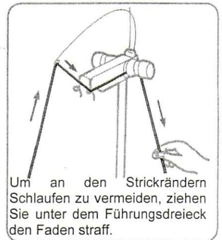
Um an den Strickrändern Schlaufen zu vermeiden, ziehen Sie unter dem Führungsdreieck den Faden straff.
