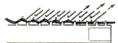
Wenn die Schlingen am Ende kleiner werden, schieben Sie die Nadeln einzeln in die B-Position zurück.
