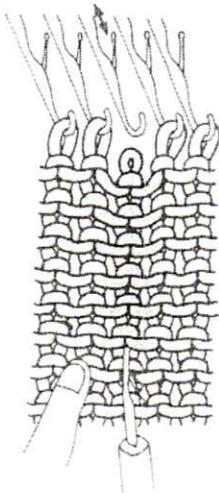
Schieben Sie die gewünschte Nadel in die D-Position und dann in die B-Position zurück. Die Masche rutscht von der Nadel. Stechen Sie mit der Arbeitszungennadel in die 6. Masche von oben ein.
