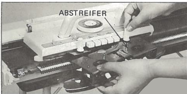
13. Lösen Sie die beiden Fingerhutschrauben am Strickschlitten.
