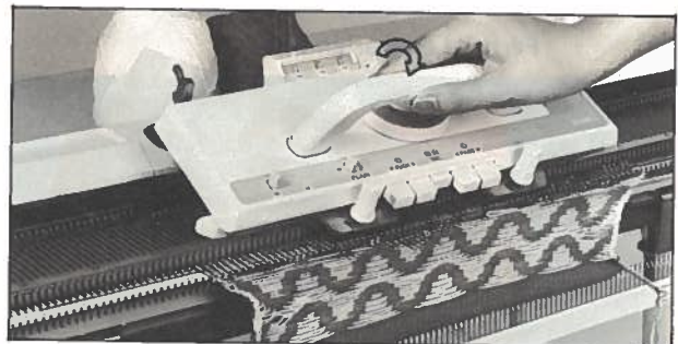
Heben Sie den Strickschlitten vom Nadelbett.
