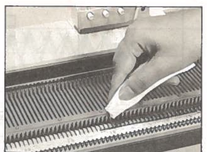
Vordere und hintere Laufschiene mit einem leichten Ölfilm überziehen.
