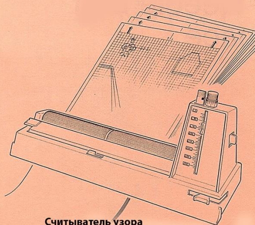
Считывает очертания изделия и в любой момент показывает требуемую операцию. Эта принадле- жность поставляется с дизайном девяти основных изделий, выполненных в различных размерах
