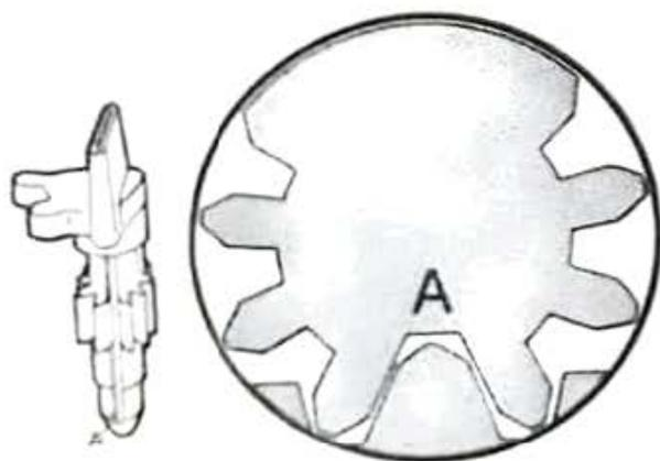
Beim Einstecken oder Herausnehmen der Umschaltstecker muß die braune bzw. schwarze Marke rechtwinklig zum Gestänge stehen. Immer die große V-Nute (A) vom Stecker über den großen V-Zahn in der Bohrung einsetzen. Die Stecker fest nach unten drücken.
