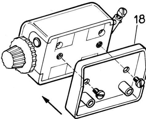
Remontez le compteur sur l'entretoise ⑱ à l'aide des vis démontées (ce sont les vis les plus courtes).
