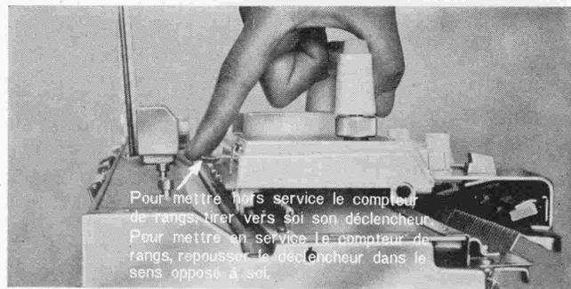
Pour mettre hors service le compteur de rangs, tirer vers soi son déclencheur.
