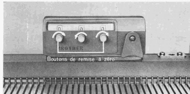
Pour remettre à zéro les chiffres du compteur, tourner, de droite à gauche, les trois boutons dans le sens des flèches.
