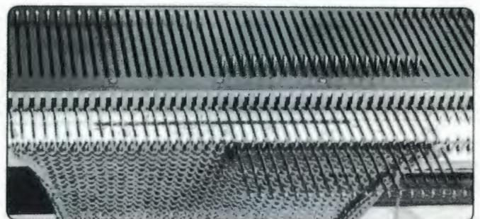
Bringen Sie die Nadeln, die in der E-Position stehen, zurück in die D-Position. Die anderen Nadeln rechts in die E-Position.
