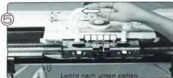
Ziehen Sie den Anfangsfaden mit der linken Hand leicht nach unten und stricken Sie LANGSAM nach links. Halten Sie den Anfangsfaden bei den ersten 4-5 Reihen weiterhin fest.
