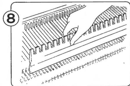
Während Sie mit der glatten Seite des Nadelschiebers die Nadeln nach unten drücken, schieben Sie die Nadelsperre wieder in das Nadelbett.
