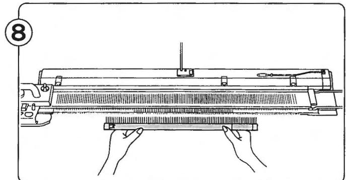
① Nehmen Sie den Anschlagkamm aus dem Kofferdeckel. Wählen Sie die Länge nach der Strickbreite. (Seite 13)
