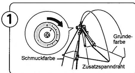
1 Fädeln Sie eine sehr feine Schmuckfarbe links ein. Fädeln Sie die Grundfarbe zusätzlich in den Zusatzspanndraht ein.
