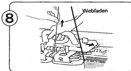
Schieben Sie den Schlitzen nach rechts. Halten Sie den Faden dabei leicht nach oben. Der Webfaden muß im rechten Webfadenführer liegen.
