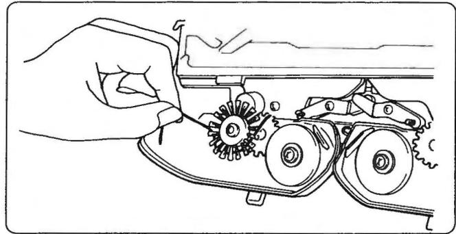
Nehmen Sie beide Schlitten vom Nadelbett und entfernen Sie Flusen und Fadenreste aus allen Bürsten. Lassen sich die Bürsten schwer drehen, entfernen, säubern und befestigen Sie diese.
