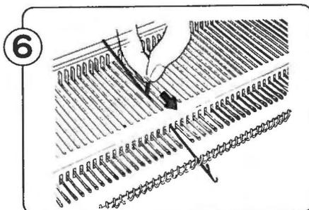
Schieben Sie die Nadel von hinten in den Nadelkanal bis zur E-Position.
