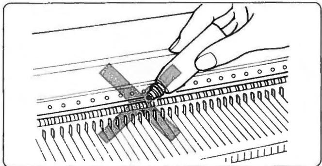
Es darf kein Öl in die Maschine laufen. Sprühen Sie keine silikonhaltigen Sprays auf die Maschine.
