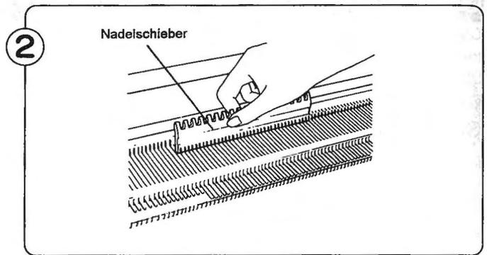
Schieben Sie die benötigte Nadelzahl in die B-Position (Rechts und links der "O" auf der Nadelzähl-folie die gleiche Anzahl).
