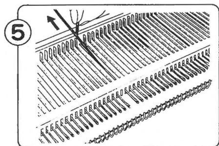
Fassen Sie die Nadel am Nadelfuß und ziehen Sie diese nach hinten aus dem Nadelbett.
