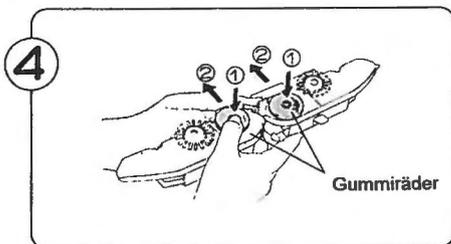
Entfernen Sie den Abstreifer vom Schlitten. Bringen Sie beide Gummiräder ① in die Arbeitsstellung ②, und befestigen Sie den Abstreifer wieder.
