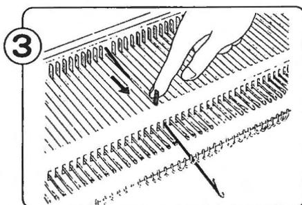
Schieben Sie die defekte Nadel in die E-Position.
