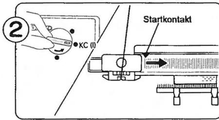
Stellen Sie den Wechselschalter auf KC (II). Schieben Sie den Schlitzen eine Reihe nach rechts.
