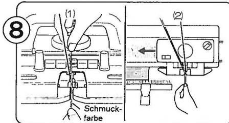
8 (1) Fädeln Sie die Schmuckfarbe in das Fadenführerstückchen "B" ein, ohne den Nüßchenhebel zu öffnen.
