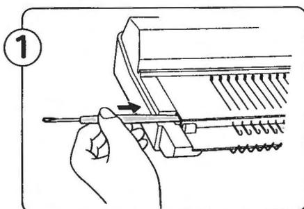
Mit dem Griff der Arbeitszungennadel drücken Sie gegen die Nadelsperre, bis die defekte Nadel frei ist.
