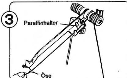
Fädeln Sie den Faden durch die Öse am Führungsarm.
