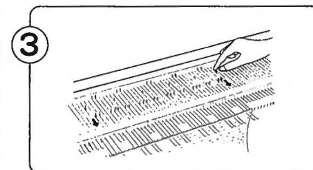
Arbeiten Sie nach den Punkten ② - ⑤ auf Seite 59 - 60. Schieben Sie in jeder Reihe die Randnadel in die D-Position, wenn diese musterbedingt in der B-Position bleibt. Stricken Sie das Muster.
