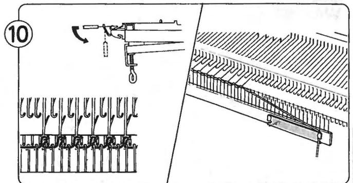
10 Hängen Sie den Kamm von oben nach unten in die Schlingen und befestigen Sie das Fadenende an der Fadenklemme (Bild).
