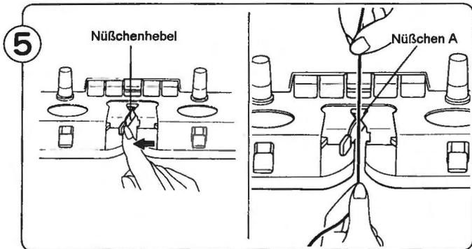
Nehmen Sie das Fadenende aus der Fadenklemme und fädeln Sie das Garn in Nüßchen "A" ein.
