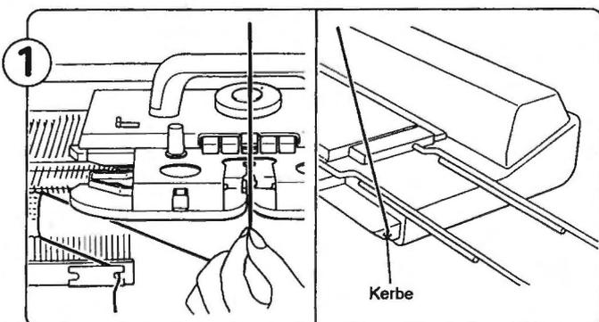
1 Entfernen Sie die Krallengewichte. Nehmen Sie den Faden aus dem Nützchen "A" und legen Sie den Faden rechts in die Kerbe.
