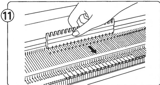
11 Schieben Sie die Nadeln, welche Sie bei Punkt 4 in die A-Position brachten, in die Position B.
