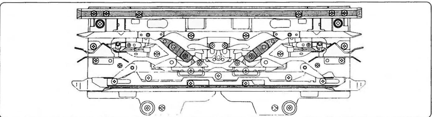
Wenn Sie die Schlittenunterseite sorgfältig gesäubert haben, ölen Sie auch die schwarzen Nocken, wie im Bild gezeigt. Je öfter Sie die Maschine ölen und reinigen, um so besser und leichter strickt sie.
