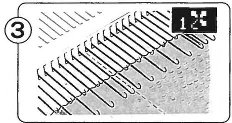
Schieben Sie den Strickschlitten nach rechts am Startkontakt vorbei. Die Musternadeln sind in die D-Position vorgewählt.
