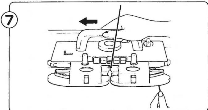
Während Sie nach links stricken, bleibt die Hand mit dem Faden an der rechten Seite des Nadelbettes. Die Nadeln der B-Position sind mit einer Schlinge belegt.
