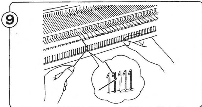
9 Ziehen Sie den Faden wie im Bild gezeigt, zwischen den Haken zu sich nach vorn.
