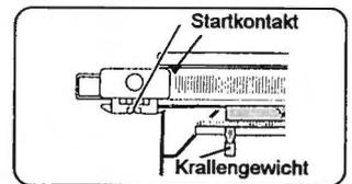
② Stricken Sie einige Reihen glatt rechts und lassen Sie den Schlitten außerhalb des linken Startkontaktes stehen. Hängen Sie Kamm und Krallengewichte ein.
