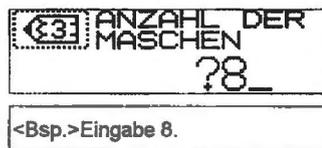
④ Geben Sie die benötigte Massenzahl mit den Zifferntasten ein und drücken Sie die ↵-Taste.
