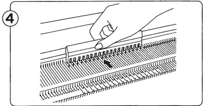
Mit dem 1/1-Nadelschieber jede 2. Nadel in die A-Position schieben.
