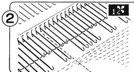
Schieben Sie den Strickschlitten nach rechts am Startkontakt vorbei.
