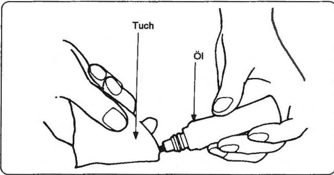
Säubern Sie die Laufschiene am Schlitten und die Führungsschneen am Nadelbett mit einem Tuch. Führungs- und Laufschiene mit einem leichten Ölfilm überziehen.
