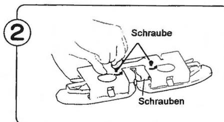
Entfernen Sie den Abstreifer und lösen Sie die beiden Schrauben.
