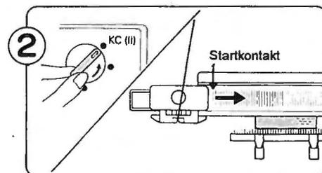
Stellen Sie den Wechselschalter auf KC (II). Schieben Sie den Schlitten eine Reihe nach rechts.
