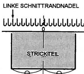
· Nadeln der linken Maschinenhälfte werden mit L(Gelb), der rechten Maschinenhälfte mit R(Grün) angegeben.
