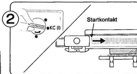
Stellen Sie den Wechselschalter auf KC (I). Schieben Sie den Schlitten eine Reihe nach rechts.
