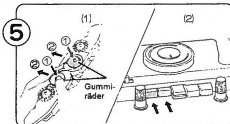
(1) Entfernen Sie den Abstreifer vom Schlitten. Bringen Sie beide Gummiräder ① in die Arbeitsstellung ②, und befestigen Sie den Abstreifer wieder.
