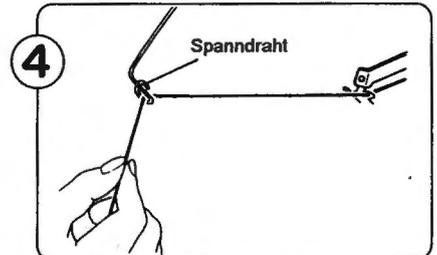
Fädeln Sie den Faden durch die Öse am Spanndraht.
