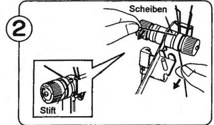
Führen Sie den Faden zwischen die beiden gefederten Scheiben. Schieben Sie mit gespanntem Faden die äußere Scheibe zur Seite. Der Faden gleitet unter den Sicherungsstift.
