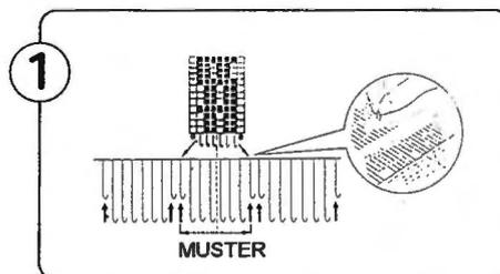
Schieben Sie die Nadeln mit der "O"-Markierung zuerst in die E-Position, dann in die A-Position. Diese Maschen werden abgeworfen. Stricken Sie in einem Teil, hängen Sie die linken markierten Maschen nach links, die rechten nach rechts auf die Nachbarnadeln um. Schieben Sie die leeren Maschen in die A-Position um. Schieben Sie die leeren Nadeln in die A-Position zurück. Die Markierungen finden Sie in den Diagrammen in der Musterwelt III.
