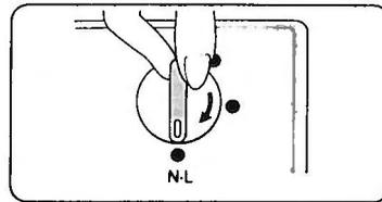
Stellen Sie den Wechselschalter auf N·L. Die MC-Tasten springen automatisch heraus.
