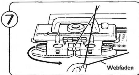
Entfernen Sie den Webfaden aus dem linken Webfadenführer. Schieben Sie den Schlitzen dabei ein wenig weiter. Der Webfaden löst sich leichter. Hängen Sie den Webfaden vor den rechten Webfadenführer.
