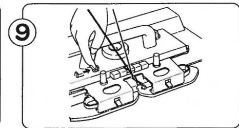
Drücken Sie die Löschtaste. Beide MC-Tasten springen heraus.
