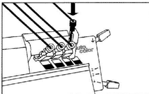
4. Den Schalthebel nach unten drücken. Ein beliebiges Nüsschen springt nach oben. Das Nüsschen nach unten drücken und so weiterfahren, bis als letztes das 4. Nüsschen nach oben gesprungen ist. Auch diese nach unten drücken und mit Stricken beginnen, wobei Sie immer bis zum Anschlag des Farbwechslers fahren.
