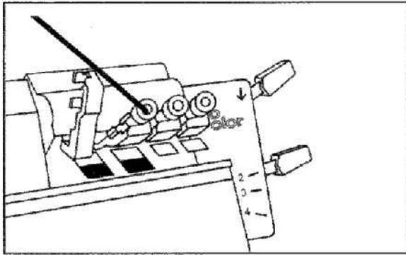
5. Bevor Sie wieder in den Farbwechsler hinfahren, die schwarze Drucktaste vor dem Nüsschen mit der zweiten Farbe nach unten drücken, während Sie gleichzeitig die Taste vor dem ersten Nüsschen unten festhalten. Beide Drucktasten müssen unten einrasten.
