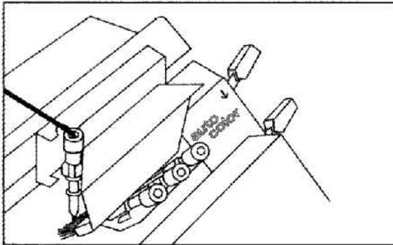
5. Mit dem Schloss bis zum Anschlag rechts in den Farbwechsler hineinfahren.
