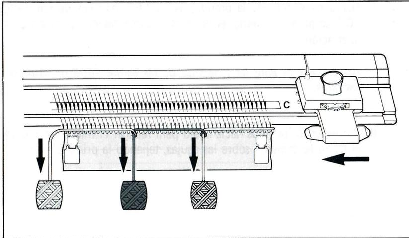
8. Sosteniendo los hilos hacia abajo para recoger el hilo flojo, mueva el Carro lentamente sobre las agujas, tejiendo la segunda hilera.
