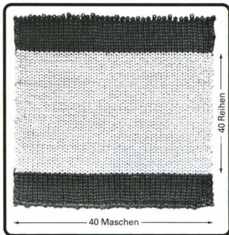
Zum Stricken mit dem FORM COMPUTER brauchen Sie **die Masse in Millimeter einer Strickprobe von 40 Reihen und 40 Maschen.** Dabei werden **nur die Maschen auf dem vorderen Bett** gezählt. Wenn das Muster nicht mit allen Nadeln des vorderen Bettes gestrickt wird, wird die Breite des Gestricks gemessen, die sich ergibt, wenn man **über eine Breite von 40 Nadeln des vorderen Bettes** strickt.
