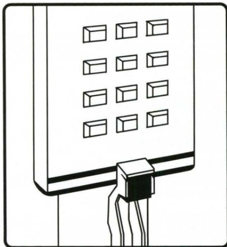
Beim Stricken mit dem Computer müssen Sie unbedingt darauf achten, dass bei jeder Reihe, die Sie stricken, der Magnet, der am hinteren Schloss angebracht ist, vor dem Computer vorbeifährt, da sonst der Computer diese Reihe nicht registriert.
