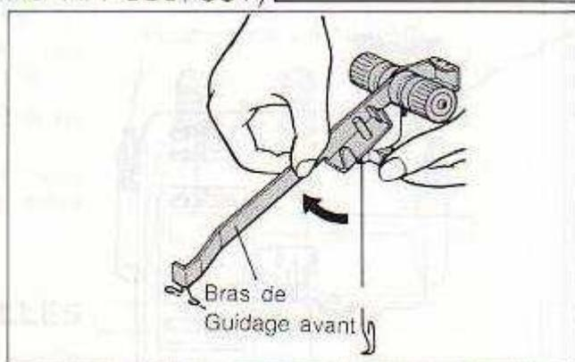
2. Soulever le bras de guidage avant pour le dégager du système de tension du fil (G).
