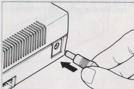
Verbinden Sie zuerst den Anschlußstecker des Netzgerätes mit der DC6V-Buchse der FB-100 und schließen erst dann das Netzgerät an das Stromnetz an.
