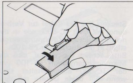
① Drücken Sie den Schnappverschluss nach vorn und entfernen die Abdeckung des Batteriefachs an der Unterseite des Gerätes.
