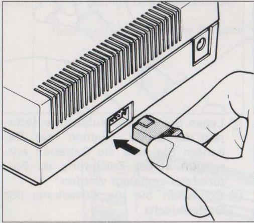
Stecken Sie das Kabel zur Verbindung mit dem TC-600, wie in der nebenstehenden Zeichnung dargestellt, in die Buchse der FB-100. Bitte achten Sie darauf, daß die Mikrodiskettenstation FB-100 und der TC-600 ausgeschaltet sind, wenn Sie beide Geräte mit dem Kabel verbinden. Dies gilt auch für den Fall, daß Sie das Kabel wieder aus einem der beiden Geräte ziehen.
