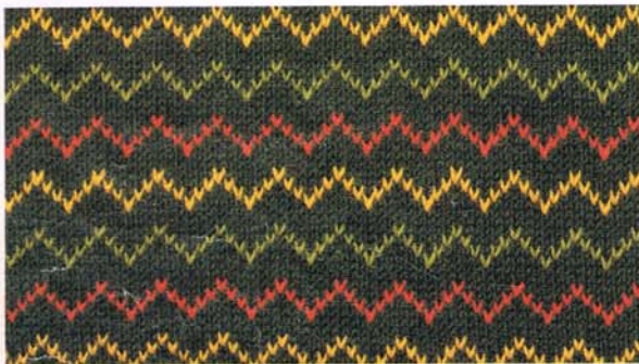
Kaart nr. 3 Na het draaien aan de selectiehendel waarbij geen naald wordt geselecteerd, twee toeren gewoon breien en overgaan op kleur 2.
