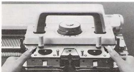
Ослабьте винты и прижимную слайд ткани на каретку. Будьте уверены, что вырезы подходят вокруг винтами и двумя кольшками каретки (стрелки) в отверстия ткани лапки.
