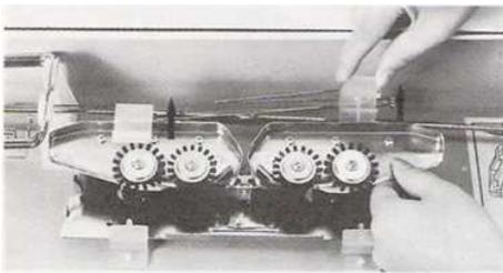
Отсоедините два рычага блокировки и удаления ткани с прижимной крышке корпуса.
