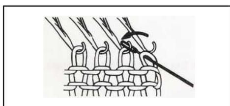
С одним инструментом передачи удалить краю стежка от его иглу и перенести его на соседние иглы внутрь вязания. Нажмите пустую иглу обратно в положение.
