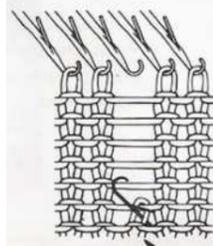
Крюк следующий свободный бар на защелку крюка инструмента. Потяните защелку инструмента, защелка закроется над баром.
