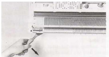
Поверните внутрь рычага селектора, насколько это возможно. Иглы выбран. Полностью вернуть рычаг селектора в исходное положение.
