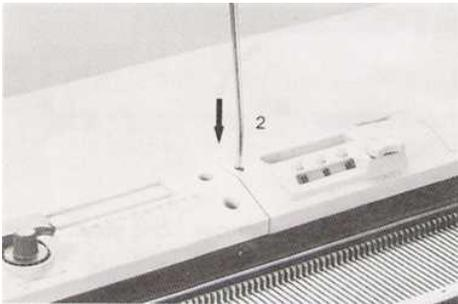
Вставьте угловой конце стержня напряжение и в паз (2). Презентация верхнего блока напряженности на стержне, в конце стержня должна соответствовать твердо в выемку напряжение блока (3).
