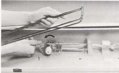
Отсоединить рычаг блокировки влево (1), и проведение расширения рельсов вверх, удалить стержень напряженности и верхний блок напряжения от крышки корпуса.
