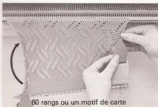
\*En mettant en place les appareillages à dentelle, les aiguilles en bout resteront toujours en B pour empêcher les mailles d'être reportées sur les aiguilles adjacentes, autrement les mailles tomberaient. Si aucune aiguille n'est sélectionnée, vérifier si la glissière de changement est positionnée sur ①.
