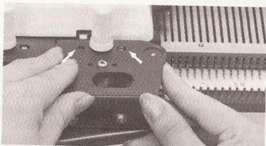
Faire coulisser les appareillages sur le chariot, et ajuster toutes les deux chevilles du chariot aux glissières des appareillages. En appuyant sur le levier de manœuvre de la came à dentelle, serrer les vis.
