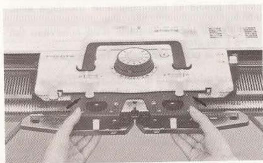
Dévisser les vis papillon et faire glisser le presseur sur le chariot ; tirer le presseur vers l'avant de telle manière que les deux découpes pratiquées autour des vis et des deux ergots du chariot (voir flèche sur la figure ci-contre), s'adaptent dans les orifices pratiqués dans le presseur.
