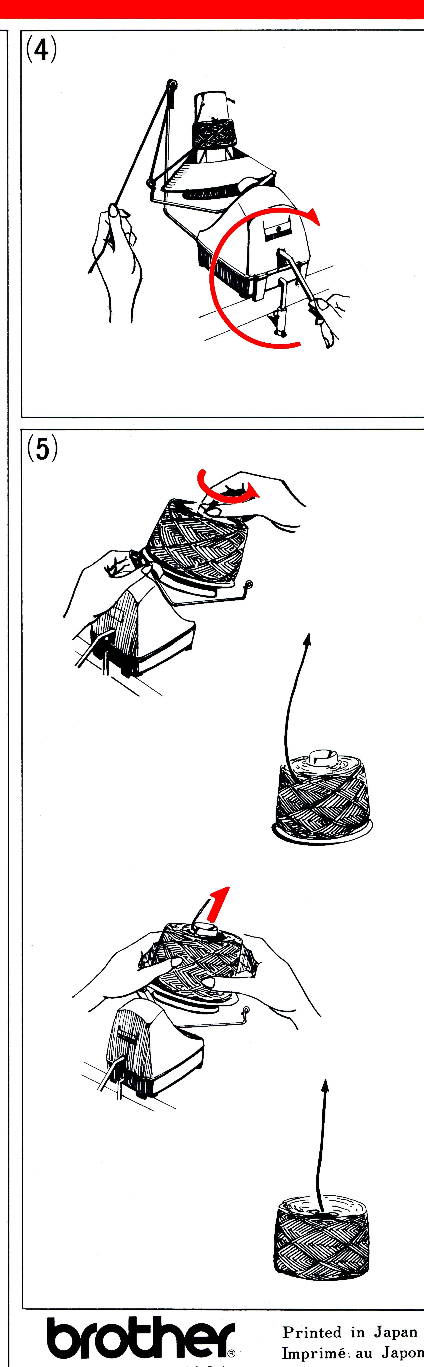
führung ein. Befestigen Sie das Fadenende in dem an der Kone befindlichen Schlitz (wie in der Abbildung gezeigt). Halten Sie mit der linken Hand die Wolle etwas stramm und drehen Sie die Kurbel nach rechts (im Uhrzeigersinn).
