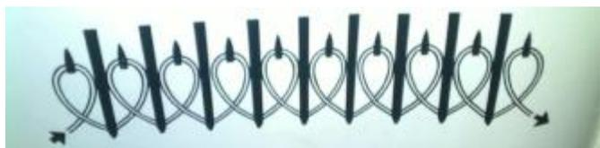
Sind alle nadeln umwickelt, so ist der fadenüberlauf nachzuspannen bis die spannfeder (Abbildung 3, pos. C) waagrecht steht. Nun sind die maschenschlingen durch Hochschieben der nadeln hinter die nadelzungen zu bringen, darauf die nadeln wieder in strickstellung zu setzen, Der Schlitten wird nun mittels des Knopfes auf die andere Seite geführt, womit die erste reihe gestrickt ist.
