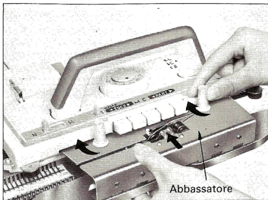
6. Sul lato sinistro del letto aghi fissare l'apposito sostegno con morsetto per l'innesto del gruppo tendifilo ausiliario. Appoggiare il sostegno con morsetto nella parte incavata della placca laterale e stringere il morsetto.
