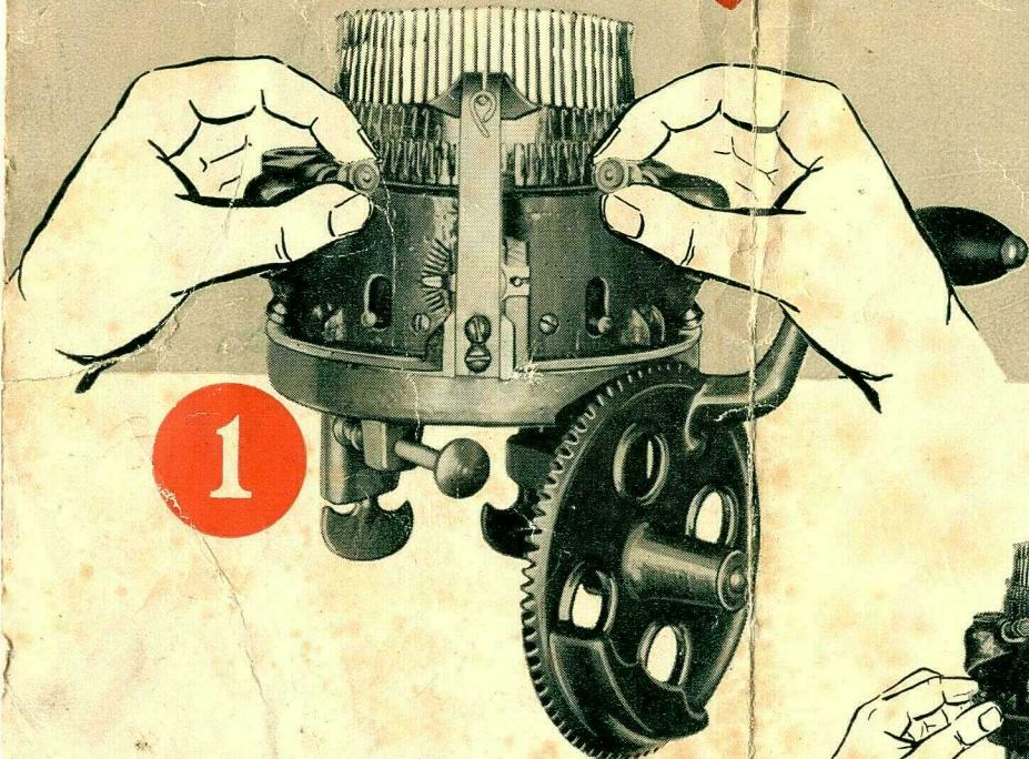
Abaïsser les leviers du bas pour mettre en action les deux piqueurs qui relèvent les aiguilles. Tenir fermement votre ouvrage à l'intérieur du cylindre, de la main gauche.
