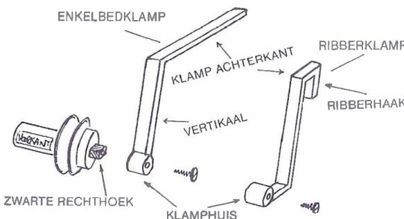
**MONTAGE** Kies de juiste enkelbed- of ribberklampen. Het label met de voorkant (FRONT) naar u toe houden en het klamphuis met de achterkant van de klamp van u vandaan op de zwarte rechthoek plaatsen. De schroef aanbrengen en aandraaien (zie schets).
