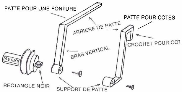
**ASSEMBLAGE** Choisir des Pattes pour Une Fonture ou des Pattes pour Côtes suivant le cas. Avec l'étiquette marquée avant orientée vers vous, placer le Support de la Patte sur le Rectangle Noir avec l'Arrière de la Patte écarté de vous. Insérer la Vis et serrer (voir le schéma).
